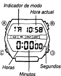
El temporizador de cuenta regresiva puede ajustarse dentro de una extensión de 1 minuto a 24 horas. Cuando la cuenta regresiva llega a cero, una alarma suena durante 10 segundos o hasta que se presiona cualquier botón.
