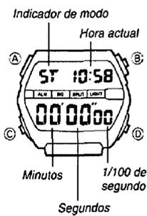
El modo de cronógrafo le permite registrar el tiempo transcurrido, tiempos fraccionados y dos tiempos de llegadas a meta. La gama del cronógrafo es de 23 horas, 59 minutos y 59,99 segundos.
