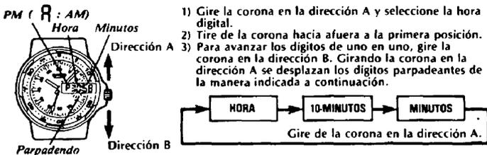
4) Para completar, empuje la corona hacia la posición normal.
