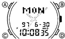
La función de visualización automática de este reloj cambia continuamente los contenidos de la visualización digital. Tenga en cuenta que no podrá usar ninguna de las otras funciones del reloj mientras está operando la función de visualización automática.
