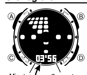
Minutos Segundos Alterna en intervalos de 2 segundos 1/100 de segundo
