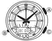
Posición correcta de la manecilla de segundos
