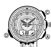
Diferencia de altitud indicada por la manecilla de segundos
