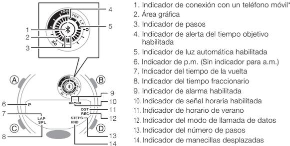
\* En el modo de indicación de la hora, mantenga presionado **(D)** durante aproximadamente dos segundos para establecer una conexión Bluetooth con un teléfono.
