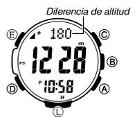
La pantalla del modo de altímetro proporciona un valor de diferencia de altitud, el cual muestra los cambios en la altitud con respecto a un punto de referencia especificado por usted. El valor de la diferencia de altitud se actualiza cada vez que el reloj tome una lectura de altitud.
