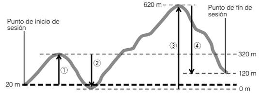
Los valores de ascenso total y descenso total producidos por una sesión de lectura en el modo de altímetro durante el ejemplo de escalada mostrado en la ilustración de arriba se calculan de la siguiente manera.
