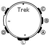
En el modo de altímetro, mantenga presionado (A) durante al menos cinco segundos. En primer lugar, destellará **Trek Hold** en la pantalla. Seguidamente, **Hold** desaparece y un puntero (■) aparece en la posición de las 12 indicando el tiempo de lectura transcurrido. Suelte (A) cuando desaparezca **Hold**.
