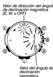
1. En el modo de brújula digital, mantenga presionado **(E)** durante al menos dos segundos. En primer lugar, destellará **SET Hold** en la pantalla. Posteriormente, **CALIBRATION** se desplazará en la parte superior de la pantalla. Mantenga presionado **(E)** hasta que **CALIBRATION** se empiece a desplazar.
