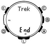
En el modo de altímetro, mantenga presionado (A) durante al menos cinco segundos. Seguidamente, destellará **Trek Hold End** y el puntero (■) de tiempo transcurrido. Posteriormente, **Hold** desaparece (A) cuando desaparezca **Hold**.
