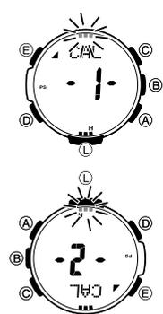
1. En el modo de brújula digital, mantenga presionado **(E)** durante al menos dos segundos. En primer lugar, destellará **SET Hold** en la pantalla. Posteriormente, **CALIBRATION** se desplazará en la parte superior de la pantalla. Mantenga presionado **(E)** hasta que **CALIBRATION** se empiece a desplazar.
