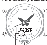
Indicador de interruptor de luz automática activado
